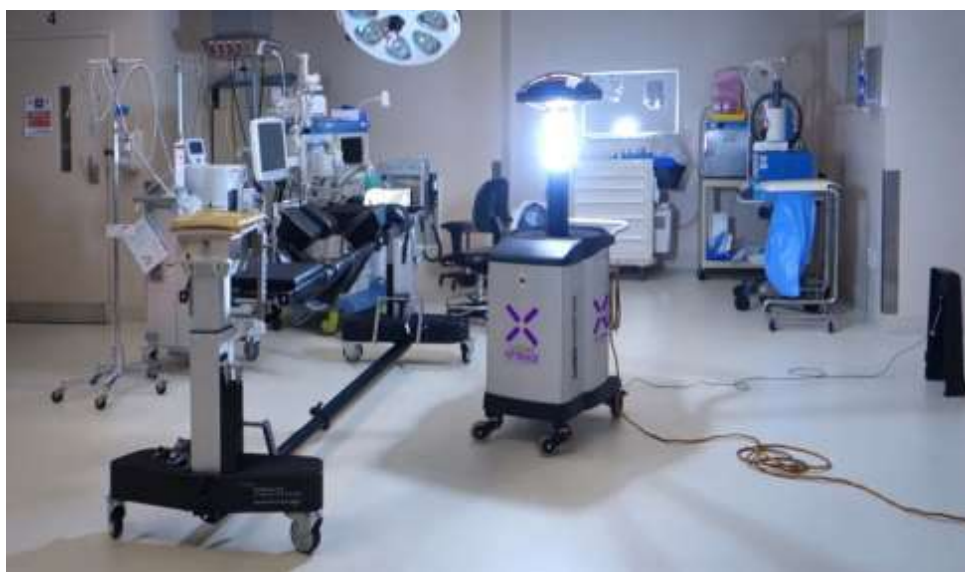
Figura 16. Desinfección UV con xenón pulsado
